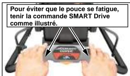
La vitesse au sol augmentera en fonction de la pression exercée sur la commande SMART Drive. Lorsque la vitesse d'avancement maximale est atteinte, l'application d'une pression supplémentaire n'augmentera pas davantage la vitesse d'avancement. Appliquer une pression suffisante pour atteindre la vitesse souhaitée.
